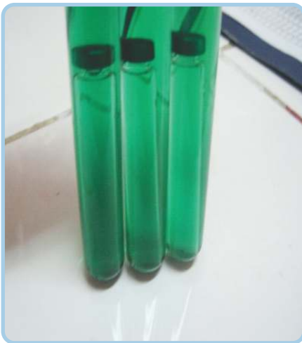
Determinación de indicadores de contaminación fecal por la Técnica del Número Más Probable (NMP/ml). Al lado izquierdo ausencia y lado derecho presencia de gas en los tubos con caldo BRILA.
