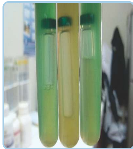
Determinación de indicadores de contaminación fecal por la Técnica del Número Más Probable (NMP/ml). Al lado izquierdo ausencia y lado derecho presencia de gas en los tubos con caldo BRILA.
